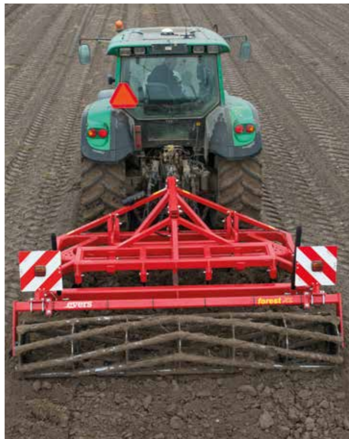
De optionele buizenrol zorgt voor een optimale verkruiemeling.
