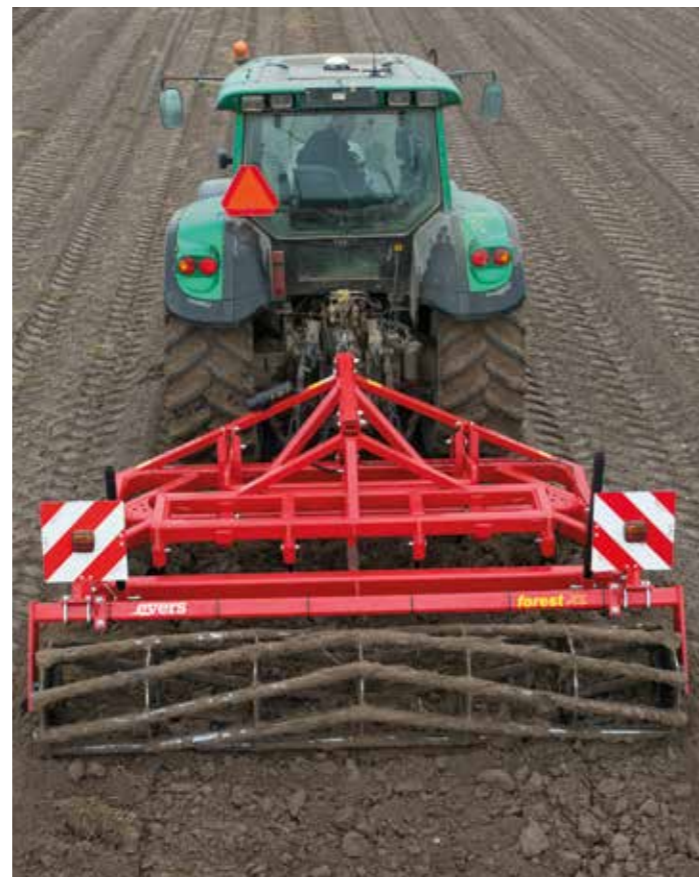
Die optionale Rohrstabwalze sorgt für eine optimale Krümelung.
