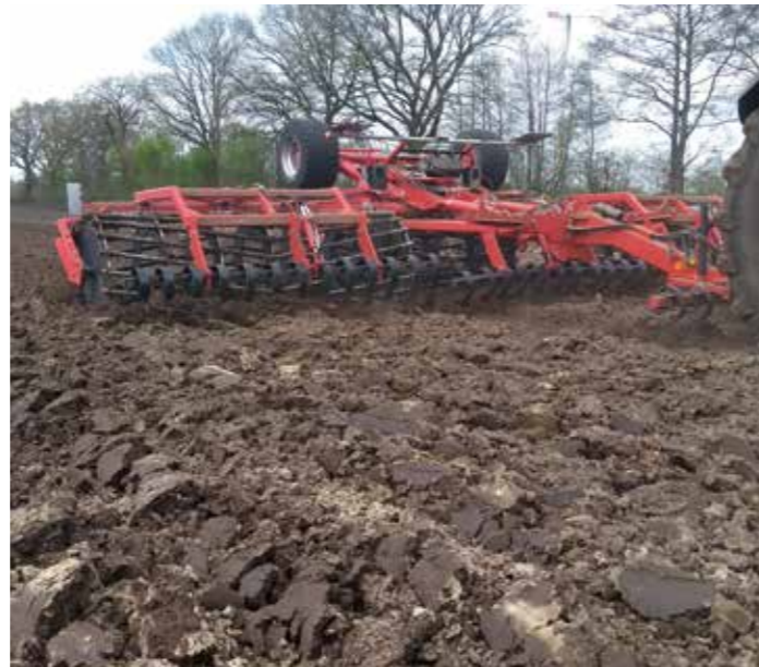
Die Concord-Ackerwalze hinterlässt auch auf schweren Böden ein ebenes, feinkrümeliges Saatbett.
