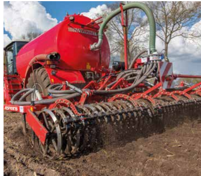
Die Dachringwalze eignet sich für die Arbeit auf fast allen Bodenverhältnissen.
