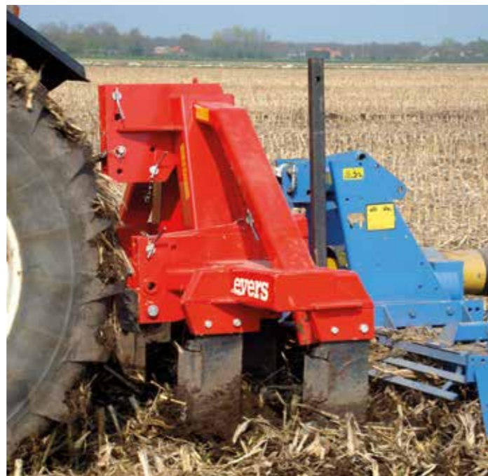
Die vier- oder sechszinkigen Vorlockerer besitzen einen universellen Zapfwellendurchtrieb für den Anbau jeglicher Zapfwellengeräte.
