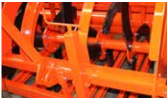
Untergrunderlockerblätter mit befestigten Scherbolzen
