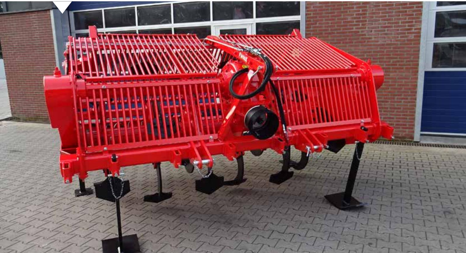
**FarmaX-Tiefenspatenmaschinen wurden zur Bearbeitung besonders tiefer Bodenschichten und zum Aufbrechen und Vermischen harter Schichten konzipiert.**
