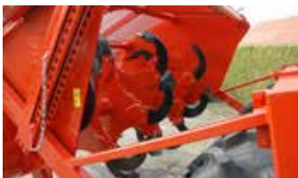
Speziell entwickelte Spaten-Messer
